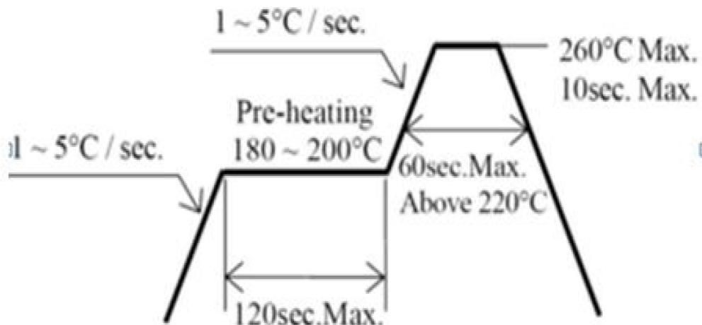
**说明:** 最多只可回焊两次, 且在首次回焊后须冷却至室温之后方可进行第二次回焊。
